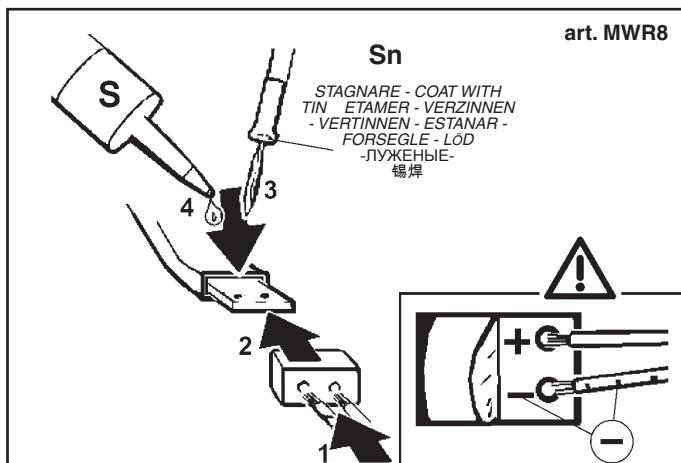
**IT** N.B.: Il grado di protezione del sistema, è garantito soltanto se si effettua correttamente l'operazione di siliconatura.
