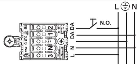
**IT** I dispositivi con cablaggio digitale possono essere dimmerati con dispositivi DALI o con pulsante normalmente aperto (N.O.) da collegare come da schema.
