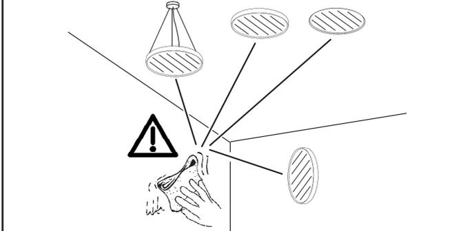
**IT** Per la pulizia ordinaria consigliamo di utilizzare acqua o detersivi neutri a base acquosa non abrasivi. Non utilizzare panni o strumenti abrasivi per eliminare lo sporco.
