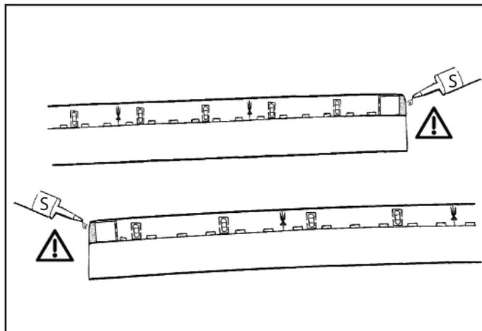
IT N.B.: Il grado di protezione del sistema, è garantito soltanto se si effettua correttamente l'operazione di siliconatura (S) con silicone fornito dalla iGuzzini.
