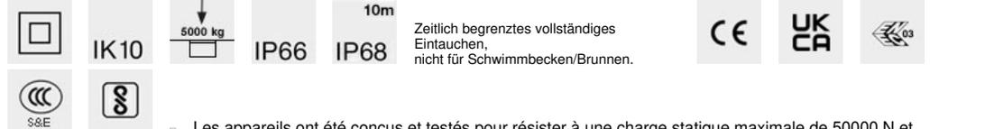
Les appareils ont été conçus et testés pour résister à une charge statique maximale de 50000 N et résistent au passage de véhicules équipés de pneus. Les appareils ne peuvent pas être installés dans les voies où ils sont soumis à des contraintes horizontales dues à l'accélération, au freinage et / ou aux changements de direction.
