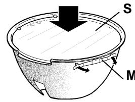
**I** Nell'installazione posizionare lo schermo "S" come in figura, agendo poi sulle molle "M" come indicato dalla freccia. Nella sostituzione dello schermo rimuovere soltanto una delle molle.
