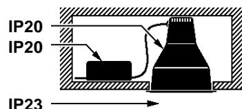
I Instalando il prodotto a plafone in un vano chiuso , il grado di protezione è quello indicato in figura.
