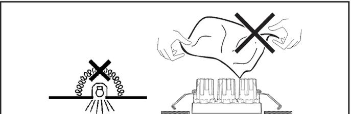
IT N.B.: Apparecchi non idonei ad essere coperti di materiale termicamente isolante
