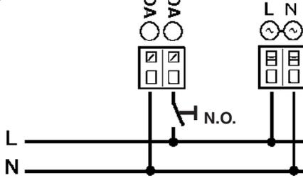
يمكن أن يتم تخفيض إضاءة الأجهزة ذات الكابلات الرقمية؛ وذلك عن طريق استخدام أجهزة الإمداد بالطاقة الكهربائية "الداي" (DALI)، أو عن طريق استخدام زر يكون مفتوحًا في وضعه الطبيعي (N.O.)، حيث يتم التوصيل كما هو مبين في المخطط.
